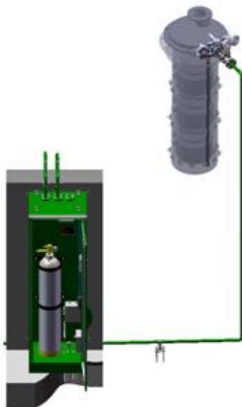
Рис.110: Труба подачи инертного газа от шкафа ТР на устройство РПН
