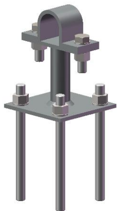
Подпорка и крепление, установленные на грунте
