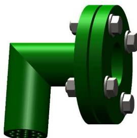
Рис. 14: Клапан ограничения доступа воздуха
