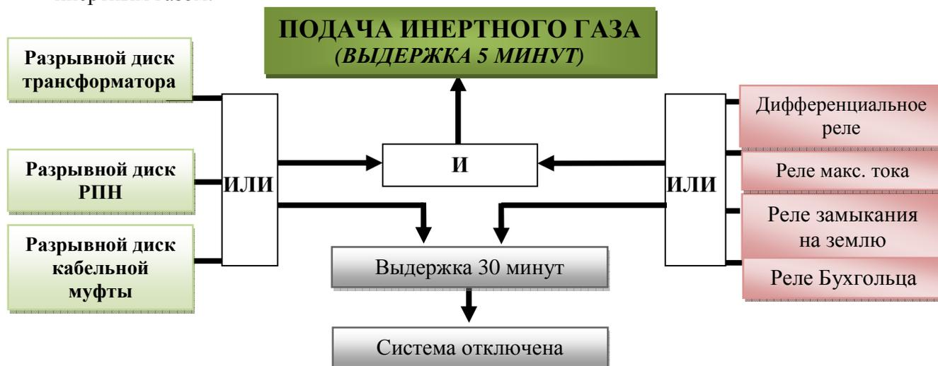
Рис. 1: Подача инертного газа в превентивном режиме
