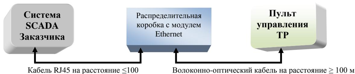
Устройство Ethernet может работать с двумя различными протоколами: Modbus/TCP или OPC. Сервер требуется только для протокола Modbus OPC. Он должен быть установлен в системе Заказчика для коммуникации с модулем Ethernet.
