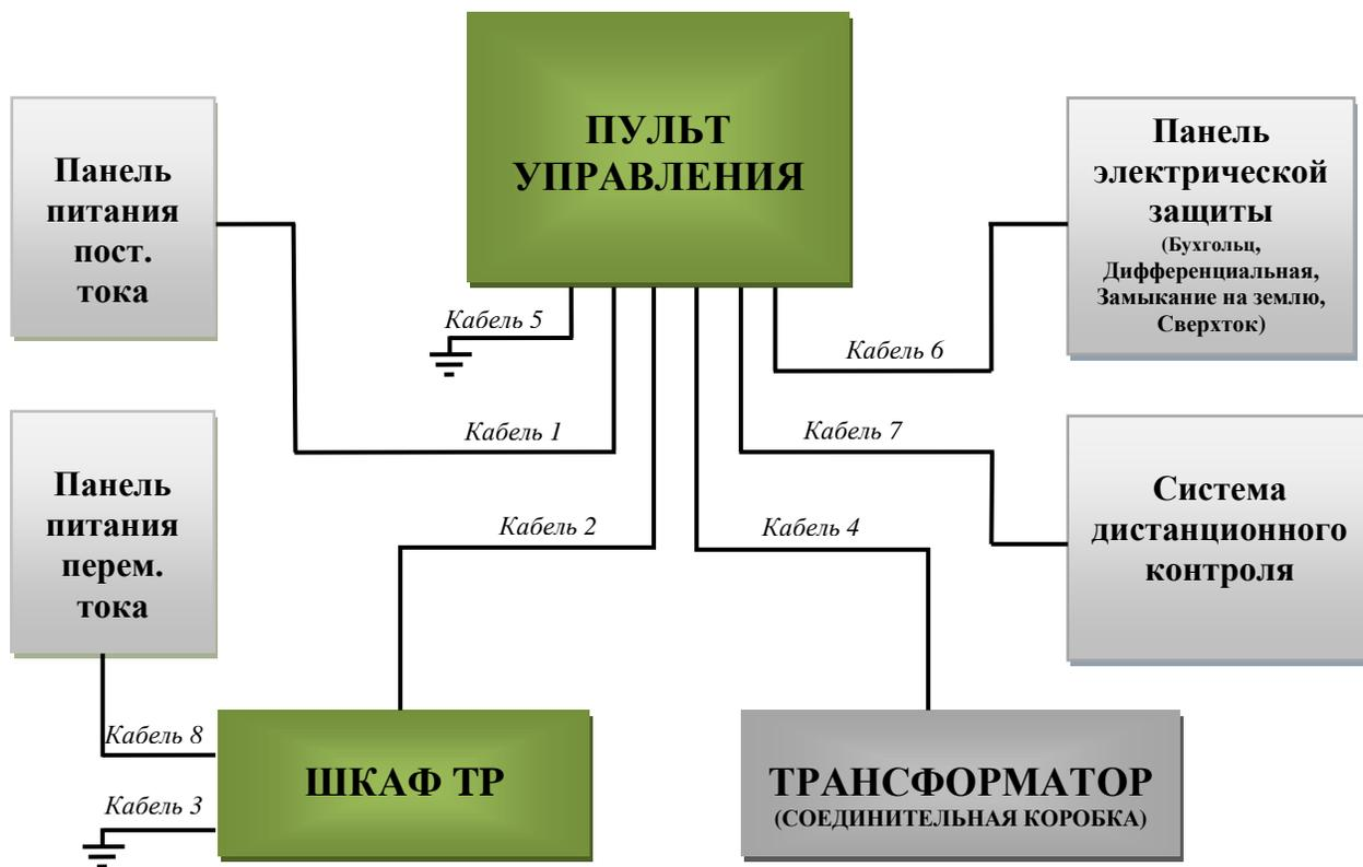
Рис.83: Пример схемы кабельных соединений
