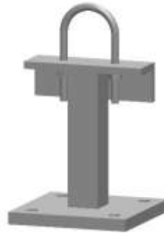
Рис. 18(б). Пример опоры ТВИГ
