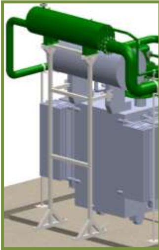
Рис. 10. Опора ПБОМГ, прикрепленная к трансформатору
