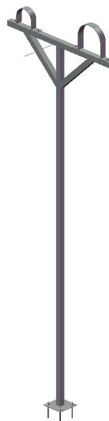
Рис. 20(в) Опора и хомуты для двух ТСМ
